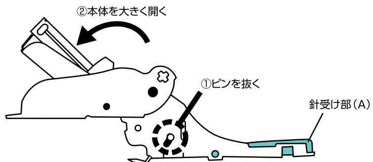
2 本体をしっかりと押さえ、針受け部（A）と本体（金属部）の間にマイナスドライバーを強くさし込む。
