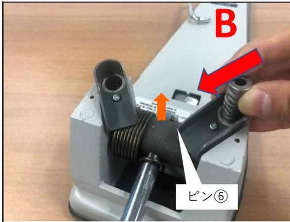
5：新しい刃を取り付ける時、刃のギアを矢印Bの方向に向けてください。
