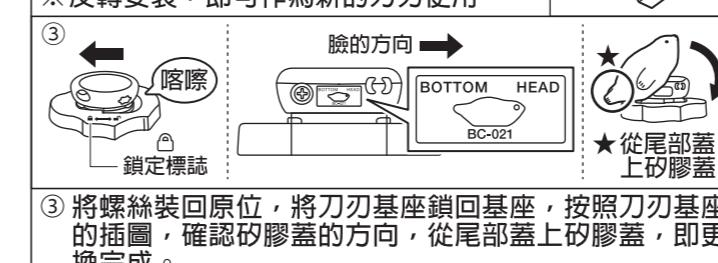
③ 將螺絲裝回原位，將刀刃基座鎖回基座，按照刀刃基座的插圖，確認矽膠蓋的方向，從尾部蓋上矽膠蓋，即更換完成。
