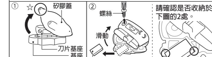
① 在鎖定於基座的狀態下，將矽膠蓋往箭頭方向卸下。
