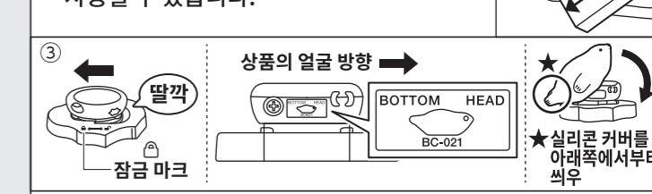
③ 나사를 원래대로 조인 후 커터부를 베이스에 다시 고정한 뒤 잠금합니다. 커터부의 그림을 참고하여 실리콘 커버 방향이 올바른지 확인하며, 실리콘 커버를 아래쪽에서부터 씌우면 교환이 완료됩니다.
