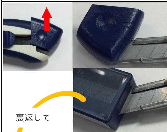
**CU-004 キャップ溝/刃折器 を使用した刃の折り方**
