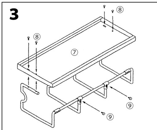
組み立てた側枠を止めネジ(小)⑧で台盤⑦の裏側から取り付けます。仕切り棒②をご使用の位置にスライドさせて、後ろ側から止めネジ(大)⑨で固定して完成です。
