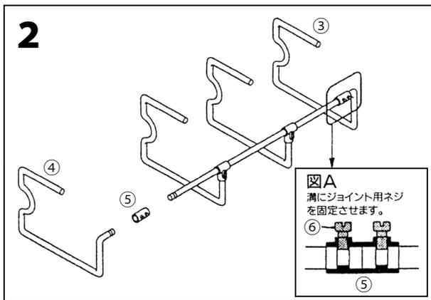
シャフト①の両端に、側枠(右)③と側枠(左)④をジョイント金具⑤で取り付け、図Aのようにジョイント用ネジ⑥で固定します。
