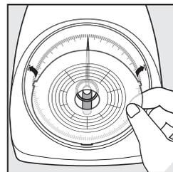
本体レンズの上部左右にある溝に郵便料金シート左右の突起(小)を差し込む
