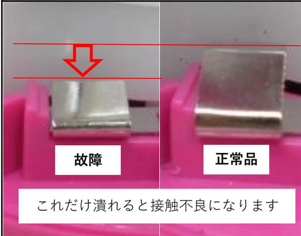
1：左図の端子部分を見て、端子の板バネが潰れているようでしたら、ラジオペンチやマイナスドライバー等で丁寧に板バネを戻してください。
