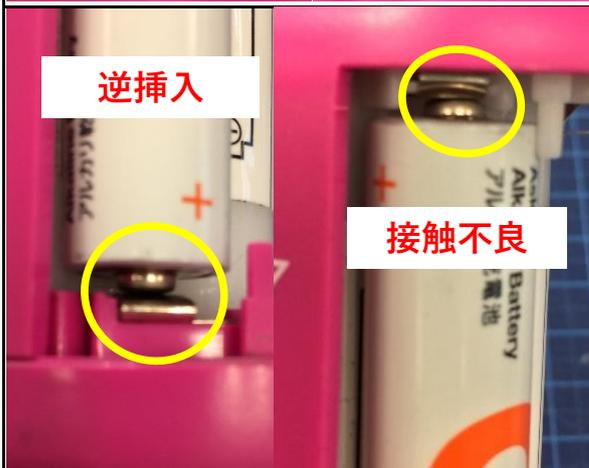
電池ボックスのマイナス側端子ですが、電池の向きを間違える（逆挿入）などで潰されてしまった場合、ごく稀にプラス側端子への押し付け力が弱まって、接触不良を起こす場合があります。
