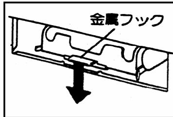
② 電池ホルダーを取り出してください。金属フックを押してプラスチック製の電池ホルダーを引き出します。
