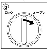
⑤開閉ハンドルを「オープン」方向、右に(時計方向に)回すと金庫のフタが開きます。
