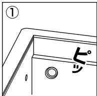
①金庫内側左壁面の登録／抹消ボタンを短く(1秒以内)押します。→「ピッ」と音がして指紋リーダーが青く点滅します。
