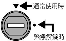
緊急解錠キーを緊急解錠キー用鍵穴に差し込み、左方向(反時計方向)に回して▼通常使用時位置(縦位置)にしてください。
